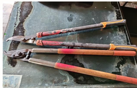
Tijeras de dos manos: Permite cortes de un poco mas de 3 cm de diámetro.
